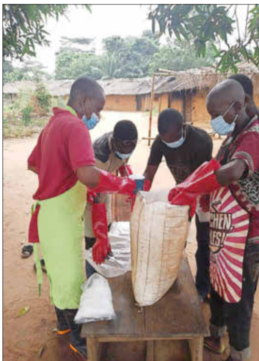
Seife wird aus Palmöl und Natronlauge gemacht - das erfordert Sorgfalt und Schutzmassnahmen bei der manuellen Herstellung. Foto: Wolfgang Leinen
